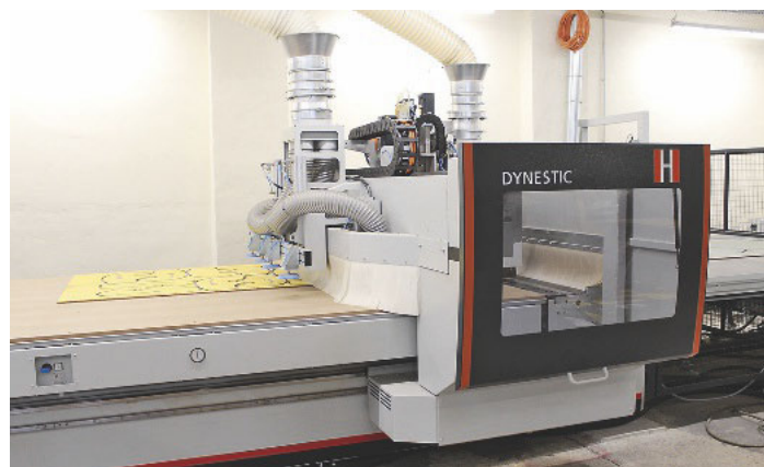
/ Der High-Flow-Nestingtisch von Holz-Her sorgt für eine sichere Werkstückspeicherung während der Bearbeitung.
