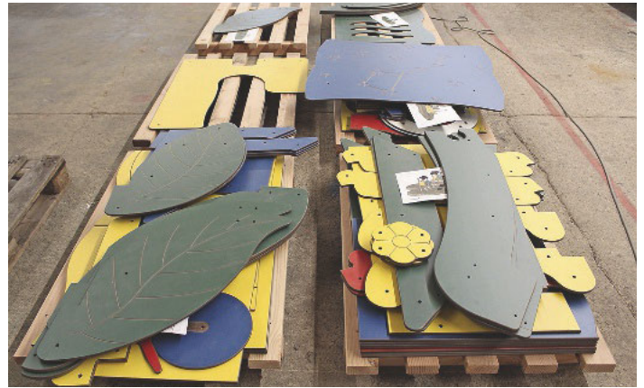
/ Klarer Fall für das Nesting-Verfahren: Organisch geformte HPL-Komponenten mit phantasievollen Gravuren und Funktionsbohrungen.
