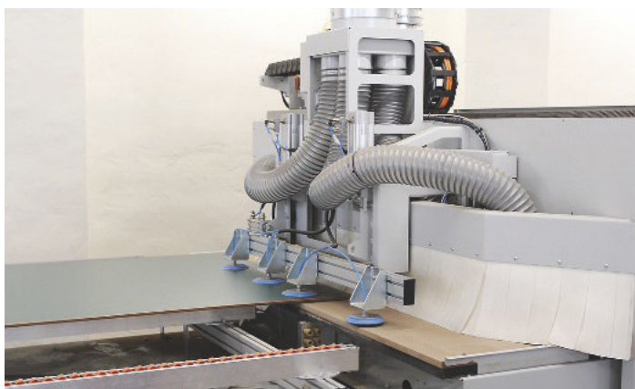
/ Materialschonend: Der Platteneinzug inklusive automatischer Positionierung auf dem automatisch abgereinigten Bearbeitungstisch.
