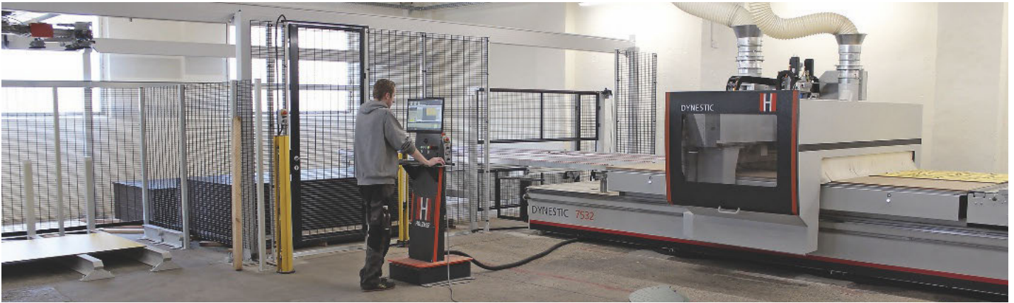
/ Im Raumwinkel kompakt eingepasst: Die Lager-Nesting Kombination bei der Sauerland Spielgeräte GmbH. Moderne Steuerungstechnik und komplette Nesting-Software machen's möglich: Das Nest wird am Monitor des standortflexiblen Bedienpults einfach aufgerufen und der Bearbeitungsablauf kann starten.
