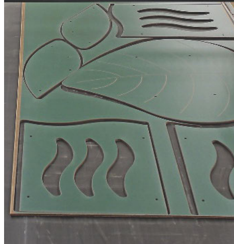
/ Saubere Sache: Das automatisch abgesaugte und fertig bearbeitete Nest auf dem Auslaufband.
